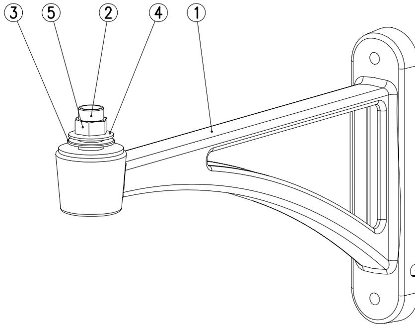
Encaje en brazo de  $\varnothing 13$  (ambos lados) para el paso del cable eléctrico de alimentación.
